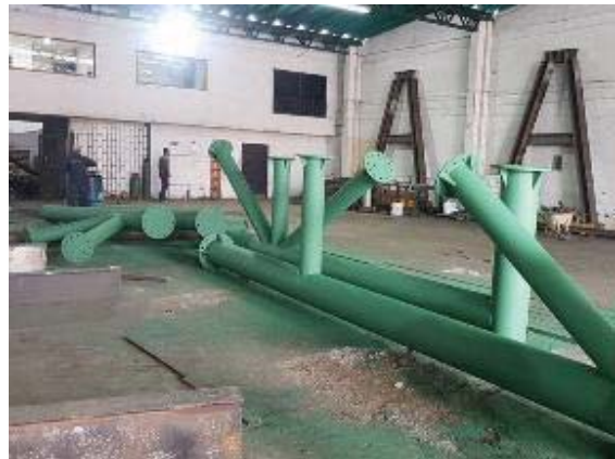
Prefabricado estructura metálica del peatonal
